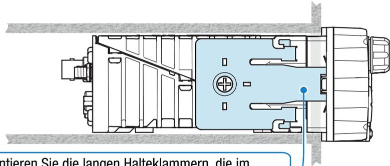
Montieren Sie die langen Halteklammern, die im Montagekit für den DIN-Einbaurahmen enthalten sind.
